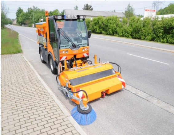
Operación de Accesorio barredora con depósito frontal (Fotografía referencial)
