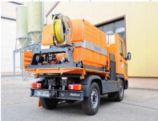
Operación de Accesorio Estanque de Agua con Pistola Hidrojet (Fotografía referencial)
