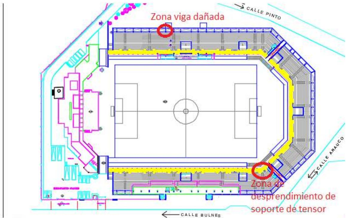
**Imagen N°1: Ubicación de viga dañada y cable (tensor) desprendido.**
