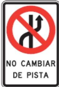
Esta señal indica a los conductores que no pueden cambiarse de la pista por la cual circulan. Se debe usar ocasionalmente y sólo cuando existan razones justificadas. En vías pavimentadas, se complementa con una línea continua en la calzada.
