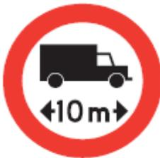
Esta señal se utiliza para regular la circulación de vehículos de un largo superior a "X" metros. Se emplea cuando los anchos de las vías o los radios de curvatura impiden a ciertos vehículos transitar sin afectar la circulación de otros o constituir un factor de riesgo. Debe complementarse con la señal de advertencia de peligro LARGO MAXIMO (PF-7).
