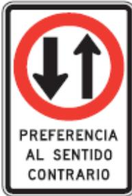
Esta señal se utiliza para indicar a los conductores que los vehículos que circulan en sentido opuesto tienen prioridad. Se instala en puentes estrechos, angostamientos de calzada, entre otros lugares. En general se usa con la leyenda “PREFERENCIA AL SENTIDO CONTRARIO”.
