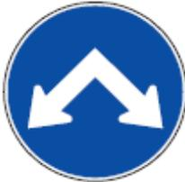
Esta señal se usa para indicar la existencia de un vértice de separación de flujos que circulan en un mismo sentido, debiendo los vehículos que circulan por la izquierda continuar por la izquierda y los que circulan por la derecha, por la derecha. Se instala en islas de canalización, a una altura no superior a 1 m sobre la vía, frente al flujo que se quiere separar.
