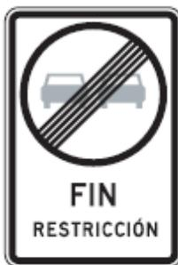
Esta señal indica el término de una prohibición o restricción previamente establecida y debe complementarse con la leyenda "FIN RESTRICCIÓN". No debe ser usada para indicar el término de una restricción de velocidad máxima, ya que en estos casos corresponde la instalación de una señal VELOCIDAD MAXIMA (RR-1) que señale el nuevo límite.
