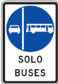
Esta señal se usa para indicar la existencia de una pista o vía exclusiva para buses. Se instala al lado derecho de la pista o vía exclusiva y al inicio de cada cuadra, resultando ventajoso, a veces, colocarla en una estructura sobre la pista o vía.
