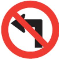
Esta señal se emplea para indicar al conductor que no puede virar a la izquierda en el sitio donde ella se encuentra. No debe emplearse sin antes tomar las medidas del caso para permitir a los conductores realizar el giro a través de otro recorrido, el que puede indicarse utilizando la señal de RUTA ALTERNATIVA (IP-1),
