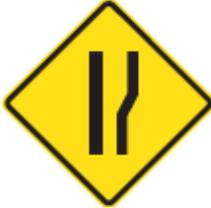
Esta señal se utiliza para advertir la proximidad de un ensanche de la calzada al costado derecho.
