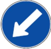
Esta señal se usa para indicar a los conductores que deben continuar circulando por el lado de la calzada indicado por la flecha. Se instala al inicio de islas de canalización, medianas y otros, a una altura no superior a 1 m sobre la vía, frente al flujo que se quiere encauzar. No debe instalarse en rotondas.
