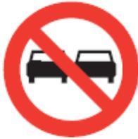
Esta señal se utiliza para indicar la prohibición de efectuar la maniobra mediante la cual un vehículo se sitúa delante de otro u otros que le anteceden, ya sea traspasando el eje de la calzada (adelantamiento), o sin traspasar dicho eje (sobrepaso). En vías pavimentadas se debe complementar con una línea continua en la calzada.
