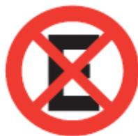
Esta señal se usa para indicar la prohibición de estacionar y/o detenerse a partir del lugar donde ella se encuentra. La prohibición puede ser limitada a determinados horarios, tipos de vehículo y tramos de vía, debiendo agregarse la leyenda respectiva. Para los efectos de precisar tramos de vía no se debe emplear flechas.
