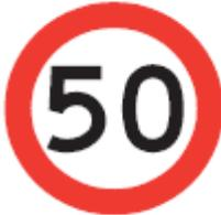
Esta señal se utiliza para indicar la velocidad máxima permitida en un tramo de vía, cuando dicho límite difiere de los establecidos en la Ley N° 18.290, de Tránsito. Su instalación requiere de un estudio previo de dicho tramo, que considere el tipo de vía, su velocidad de diseño y de operación, la accidentalidad registrada, el uso del suelo del sector adyacente, etc.
