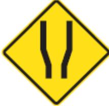
Esta señal se utiliza para advertir la proximidad de un ensanche de la calzada a ambos lados.
