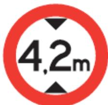
Esta señal se instala para indicar la altura máxima que permite un túnel, puente, paso a desnivel u otros elementos. Se debe colocar siempre que dicha restricción sea menor a 4,3 m.
