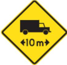
Esta señal se utiliza para advertir que más adelante en la vía, los anchos de ésta y/o sus radios de curvatura, impiden la circulación con seguridad de vehículos cuyo largo es superior a "X" m.
